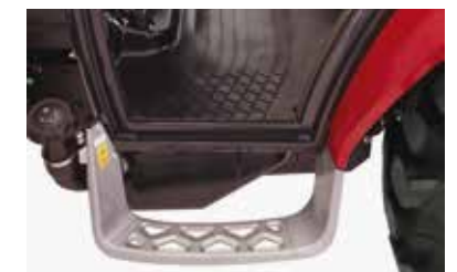
Vlakke doorlopende vloer en grote opstapree met antislip
